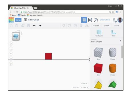
Mit einem Klick auf die gewünschte Seite des Ansichtsnavigator kann schnell zwischen den 6 Seiten Oben, Frontal, Links, Rechts, Oben, Unten gewechselt werden.
