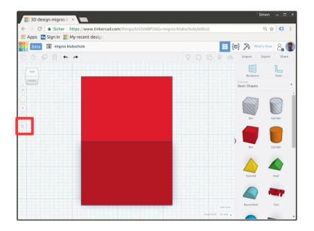
Mit dem untersten Icon kann zwischen Zentralprojektion und Parallelprojektion gewechselt werden.
